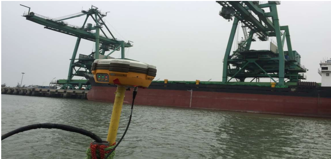
Khảo sát luồng, vũng quay và khu nước trước bến cảng Nhà máy Nhiệt điện Nghi Sơn 1 Navigable Channel survey in front of Jetty of Nghi Son 1 Thermal Power Plant
